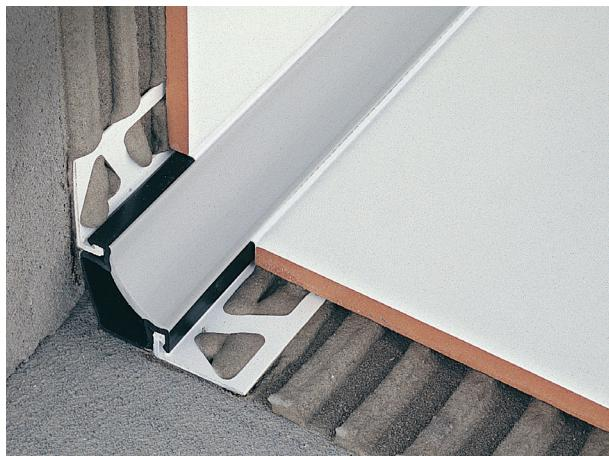
Profilé à gorge, COFLEX CR permet l'exécution parfaite des joints périphériques en garantissant en même temps un raccord hygiénique correspondant aux normes et en créant une barrière phonique contre la transmission des bruits. La gamme COFLEX CR se compose du module de base CR 16 en co-extrusion souple/ rigide et du profil KeraJolly-P enfilé dans le module de base CR 16 afin de réaliser l'ancrage sol/ mur suivant les hauteurs adaptées aux carrelages du sol et du mur.
